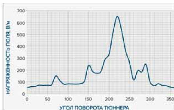
График зависимости напряженности поля от угла поворота «тюнера» на частоте 1 ГГц при подводимой мощности 35 dBm
